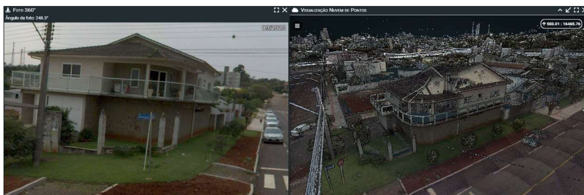
Análise 360 ° e nuvem de pontos, que quase permite ver as paredes internas da residência. Fonte: Disponibilização Geodados
